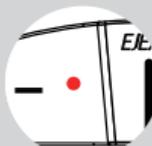
Cuando la batería está baja, la luz roja parpadea dos veces rápidamente y hay un mensaje de voz de "batería baja". Cuando la batería está extremadamente baja, el dispositivo se apaga automáticamente.
