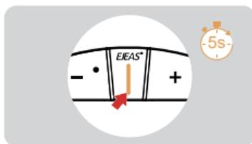
1 Después de encender el dispositivo, mantenga presionado (aproximadamente 5 segundos) el <Botón de función> hasta que las luces roja y azul parpadeen alternativamente y la voz indique "Emparejamiento del teléfono".
