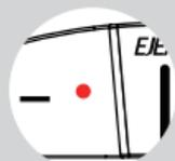
Lorsque la batterie est faible, le voyant rouge clignote deux fois avec une invite vocale « Batterie faible ». Lorsque la batterie est extrêmement faible, l'appareil s'éteint automatiquement.
