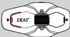
Lorsque la batterie est faible, le voyant rouge clignote deux fois rapidement et il y aura une invite vocale indiquant "batterie faible". Lorsque la batterie est extrêmement faible, l'appareil s'éteint automatiquement.
