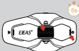
Appuyez et maintenez enfoncé le <bouton Téléphone/Alimentation> + <Bouton de la molette de défilement> pendant environ 5 secondes, le message vocal « Restaurer les paramètres par défaut », supprime l'enregistrement d'appairage, puis redémarre automatiquement le téléphone.
