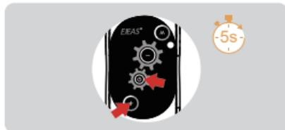
2 L'autre interphone entre dans l'état d'appairage en utilisant le même opération. Après les deux interphones découvrent chacun l'autre, l'un d'eux lancera la connexion d'appairage.
