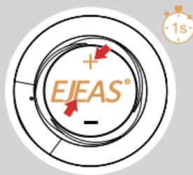
Bei Verwendung von Mesh Intercom können Sie das Mikrofon durch kurzes Drücken der <Lautstärke + >+<Funktionstaste> stummschalten, sodass der Ton Ihrer eigenen Stimme nicht an andere gesendet wird.
