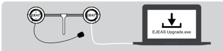
Mit einem USB-Datenkabel an den Computer anschließen. Laden Sie die Upgrade-Software „EJEAS Upgrade.exe“ herunter und öffnen Sie sie. Klicken Sie zum Starten auf die Schaltfläche „Upgrade“ und warten Sie, bis das Upgrade abgeschlossen ist.
