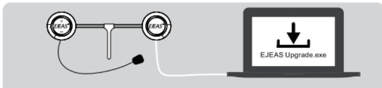
Connectez-vous à l'ordinateur avec un câble de données USB. Téléchargez et ouvrez le logiciel de mise à niveau « EJEAS Upgrade.exe ». Cliquez sur le bouton « Mise à niveau » pour démarrer et attendez la fin de la mise à niveau.
