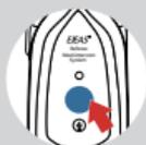
Pressione brevemente o <Botão Intercom> e será exibido "Enter Mesh System". Depois de um tempo, será exibido "Emparelhamento com sucesso" e você poderá iniciar o intercomunicador.
