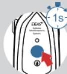
Para desligar o intercomunicador Mesh, pressione e segure a <tecla intercom> (cerca de 1s) e será exibido "O sistema Mesh está desligado"
