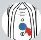
Appuyez brièvement sur le <bouton Intercom> pour couper le microphone, et le message « Microphone Mute » s'affichera. Appuyez à nouveau brièvement sur le <bouton Intercom> pour réactiver le son, et le message « Microphone Unmute » s'affichera.
