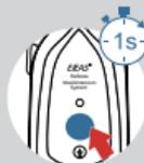
Pour désactiver l'interphone Mesh, appuyez et maintenez la touche <Intercom key> (environ 1 s), et le message "Le système Mesh est arrêté" s'affichera.
