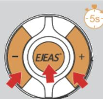
Presione y mantenga pulsado el botón < Phone / Power > + < Volume + > + <Volume - > unos 5 segundos, y la voz le indicará "restaurar la configuración predeterminada" para eliminar el registro de emparejamiento, y luego reiniciará automáticamente el teléfono.
