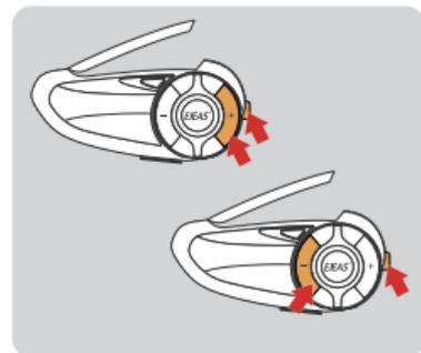
Hay cinco canales, presione brevemente el "botón del intercom" + <volumen - > / < volumen + > para cambiar el canal hacia adelante o hacia atrás. Tenga en cuenta que todo el equipo necesita mantener los mismos canales para hablar entre sí.
