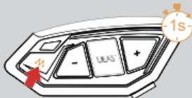
要关闭Mesh对讲，长按<M键>（约1s），语音提示“Mesh系统关闭”。
