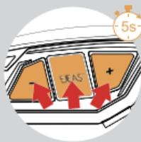
长按<电话/开机键>+<加号键>+<减号键>约5s，语音提示“恢复默认设置”，删除配对记录，然后自动重新开机。
