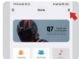
③ 打开APP，点击右上角蓝牙图标，界面显示搜索到对讲机设备名，选择要连接的对讲机设备名，点击即可连接。
