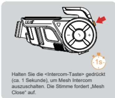
Wenn das Gerät ausgeschaltet wird, ohne die Gegensprechanlage auszuschalten, wird die Gegensprechanlage beim nächsten Einschalten automatisch wiederhergestellt.
