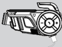
Mit einem USB-Datenkabel an den Computer anschlieen. Laden Sie die Upgrade-Software „EJEAS Upgrade.exe“ herunter und offnen Sie sie. Klicken Sie zum Starten auf die Schaltflache „Upgrade“ und warten Sie, bis das Upgrade abgeschlossen ist.
