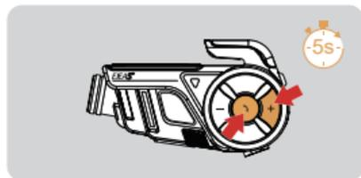
① 长按<电话/开机键>+<加号键>（约5s）直到红蓝灯交替快闪，并有配对语音提示“蓝牙对讲配对”。
