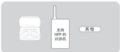
③ 此时对讲机正在搜索其他处于配对状态的对讲机，搜索发现其他对讲机后，发起配对连接。
