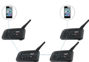
Schema dell'accoppiamento dei quattro V4
